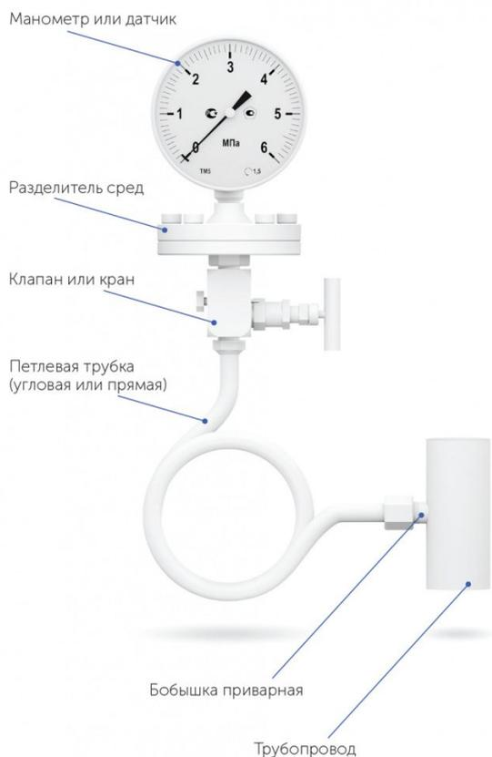
Типовой узел отбора для подключения манометра состоит из [приварной бобышки](#) с площадкой под [уплотнительную прокладку](#), [петлевой трубки](#), [трехходового крана](#) или [игольчатого клапана](#). В качестве уплотнения в резьбовых соединениях между приварной бобышкой, краном и манометром рекомендуется применять [паронитовую](#), [фторопластовую](#) или [медную прокладку](#).
